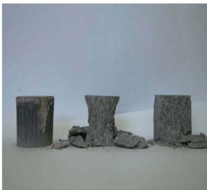
Figure 9 : Cônes de frettage et mode de rupture des éprouvettes de sable traité, pour  $\lambda = 1$ .
