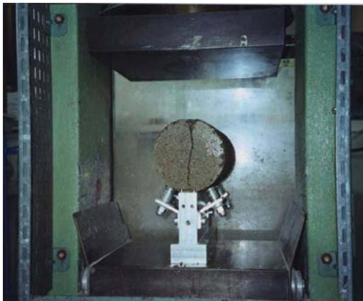
Figure 13 : Dispositif pour l'essai de fendage et mode de rupture de l'éprouvette
