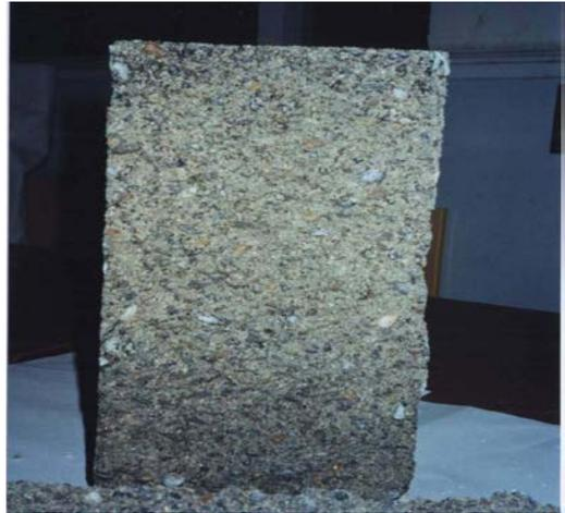
Figure 14 : Section de rupture, d'une éprouvette témoin de grave traitée présentant une distribution homogène des grains
