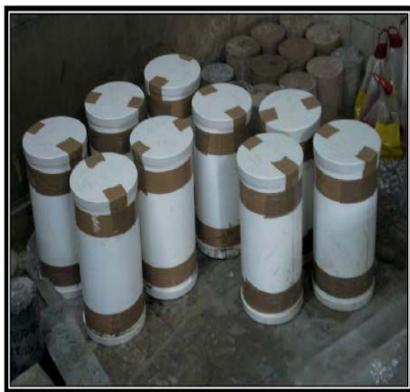
Figure 8 : Conservation des éprouvettes dans la salle humide
