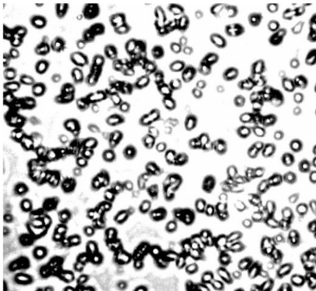
Figure 3 : Traces des particules chargées issues de la réaction nucléaire ^{10}\text{B}(n,\alpha)^7\text{Li} observées dans le détecteur solide de traces nucléaire CR-39.
