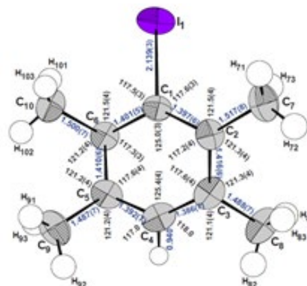
Figure. 1. Conformation moléculaire de l'ID à 293 K avec des ellipsoïdes de déplacements atomiques représentés à 50% de probabilité donnant les longueurs et les angles de liaison intramoléculaires.
