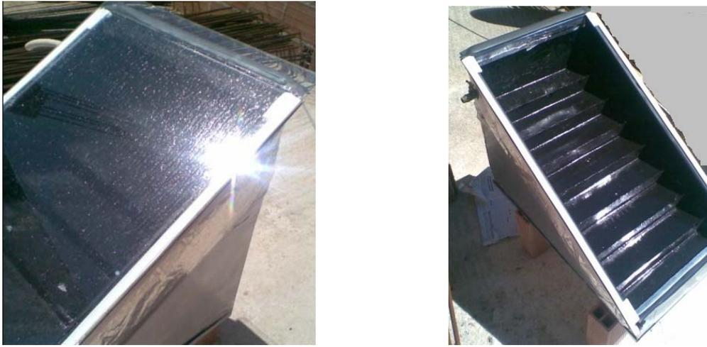
Figure. 2: Schéma du distillateur solaire à cascade
