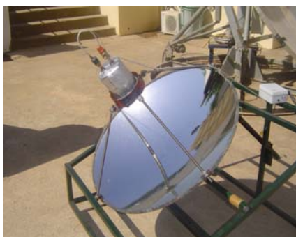
Figure.3 Exposition du concentrateur au soleil
