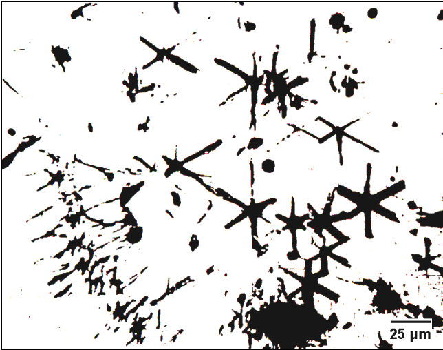
Figure 4: Veinules de Zn métallique dans les couches minces ZnO.
