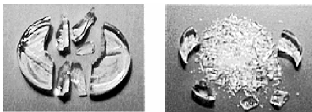
Figure 2: Rupture statique à gauche et dynamique à droite.
