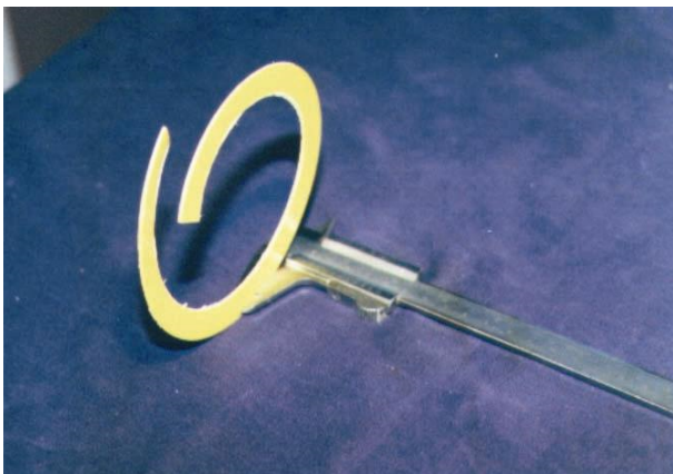
Figure 4: Déplacements dans une éprouvette sectionnée dans la direction radiale indiquant l'évolution tridimensionnelle des déformations résiduelles.
