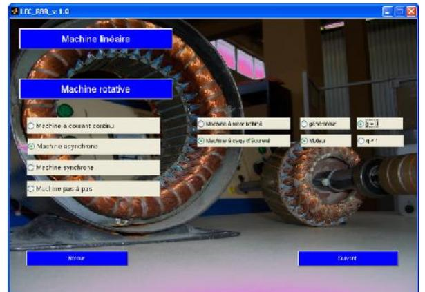
**Figure 5** : Interface du logiciel LEC\_RBR pour la conception du moteur asynchrone
