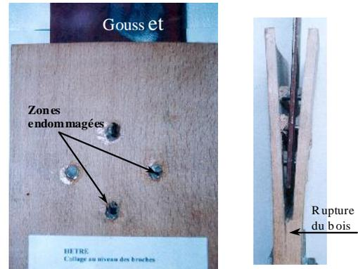
**Figure 3 :** Éprouvette rompue, cas du hêtre
