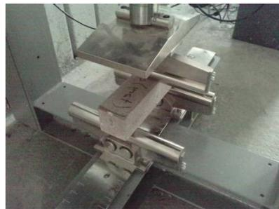
**Photo 7** : Dispositif de traction par flexion trois points
