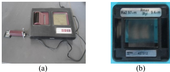
Figure 4 : (a) Rugosimètre MITUTOYO, (b) Etalon d'étalonnage du rugosimètre.
