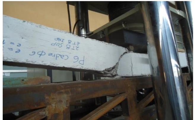
**Figure 4 :** Endommagement de la poutre P 6
