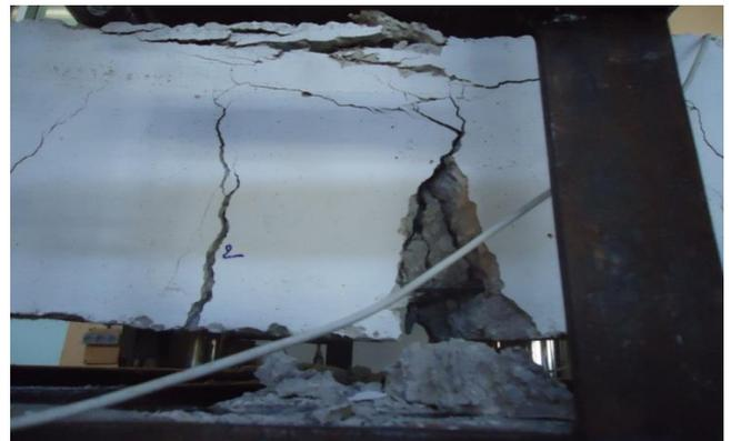
**Figure 5 :** Endommagement de la poutre P36
