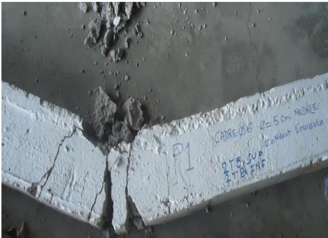
**Figure 3 :** Endommagement de la poutre P1
