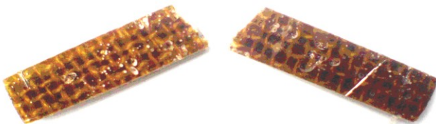
Figure 6 : Exemple d'éprouvette endommagée en choc
