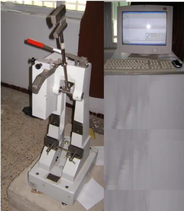
Figure 2 : Machine de choc Charpy type Zwick/Roell utilisée
