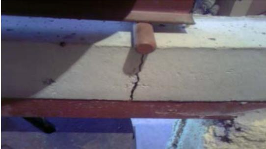
**Figure 6 :** Fissuration et rupture d'une poutrelle (10x10x120 cm ; âge de chargement 7 j.)
