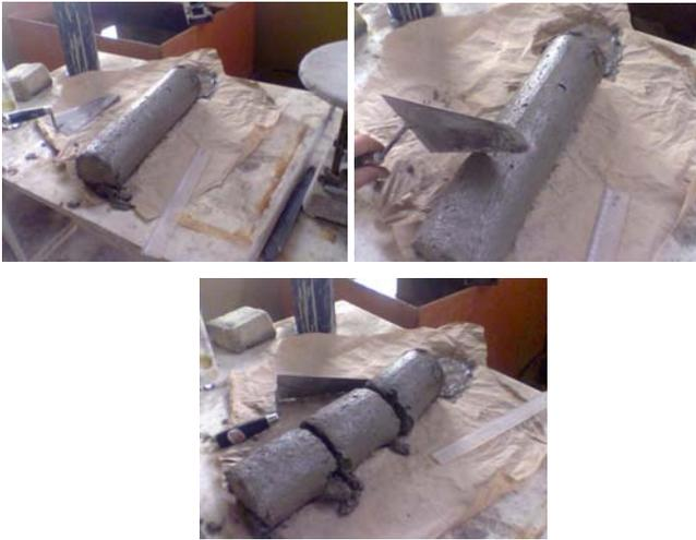
**Figure 4 :** Les différentes étapes de l'essai de mesure de l'indice de ségrégation statique.
