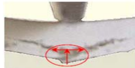
Figure 3 : Mode de rupture par flexion trois points sur éprouvette élancée
