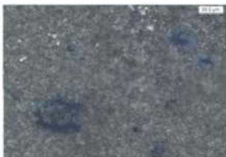
Figure 1 : Image microscopique de l'acier revêtu après 10 min d'attaque par la solution agressive
