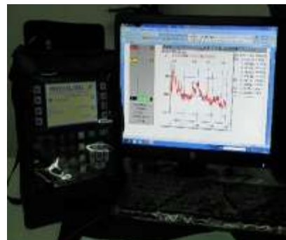
Figure. 4. Le système d'acquisition piézoélectrique sur le palier vibratoire
