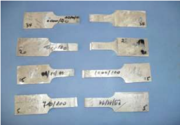
Figure 7 : Types d'éprouvettes utilisées pour les essais de traction
