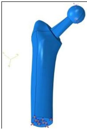
Figure 7 : Conditions aux limites et de chargement
