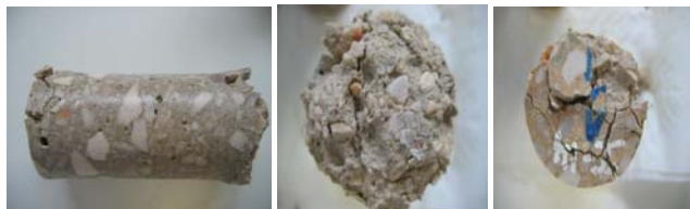
Figure 6 : Photographies des échantillons de béton CEMII/49 ayant subi l'immersion complète
