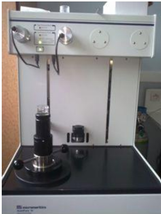
Figure 1 : Appareil de mesure de la porosité au mercure du CRMD (postes à haute et basse pression).
