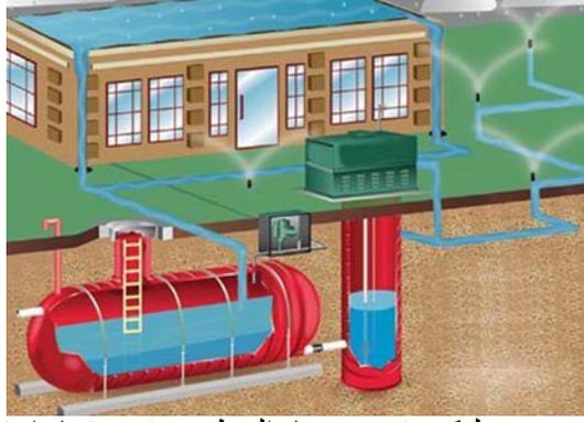
صورة رقم: رسم توضيحي لفكرة تجميع مياه السطوح، تصفيتها، استعمالها واستغلالها.
